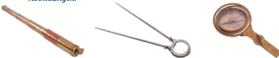
Das **Fernrohr** ist ein optisches Gerät mit Sammellinsen. Weit entfernte Gegenstände kann man damit scheinbar näher (und besser) sehen als mit bloßem Auge.
